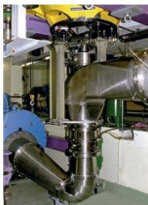
Turbine Axiale de type Saxo sur le stand d'essais
